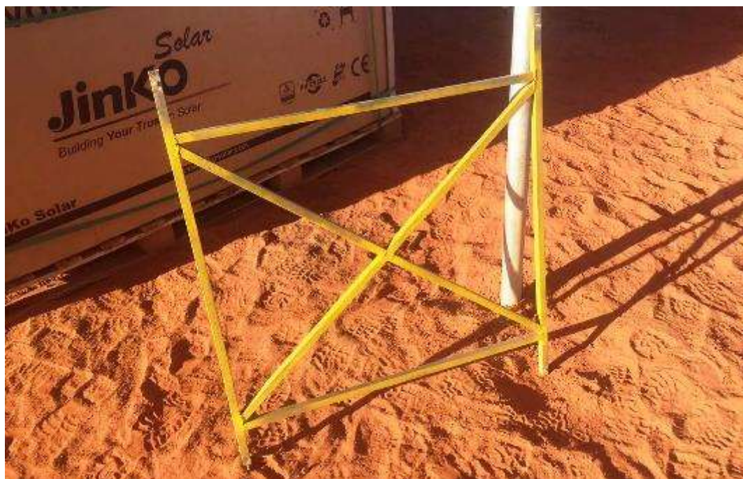
Figura 3.12 - Gabarito para montagem dos perfis de sustentação das placas
